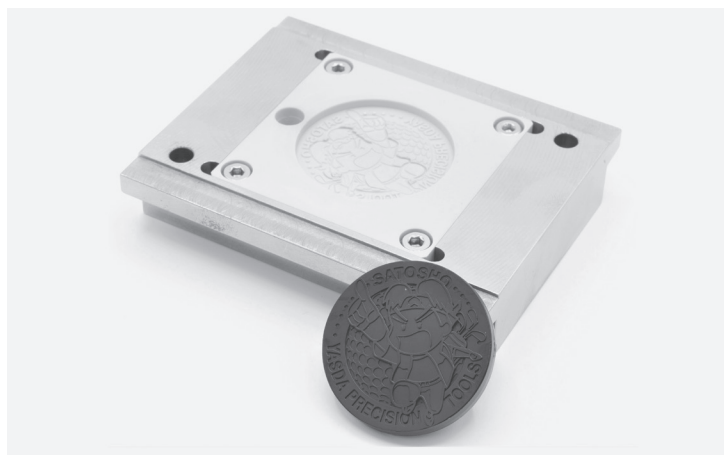
写真② 緻密な形状の樹脂型と成形品（直径約40mm）
